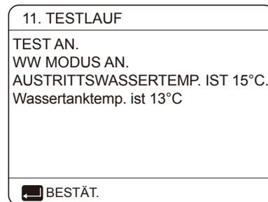
Während des Testlaufs des WW-MODUS beträgt die voreingestellte Solltemperatur des Brauchwassers 55°C. Der TBH (Tank-Boost-Heizung) schaltet sich ein, nachdem der Kompressor 10 Minuten lang gelaufen ist. Der TBH schaltet sich 3 Minuten später aus, die Wärmepumpe arbeitet, bis die Wassertemperatur auf einen bestimmten Wert steigt oder der nächste Befehl empfangen wird.
